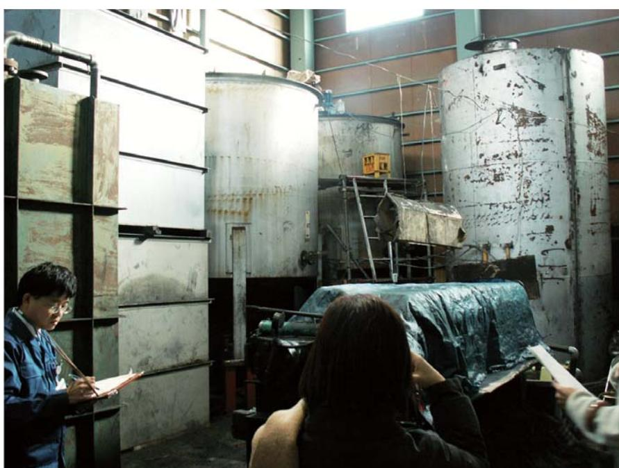
むき出しの電気コードや安全対策を施さずに設置されたタンクなど、いつ事故が発生してもおかしくない危険な工場で、不正軽油は作られている。
