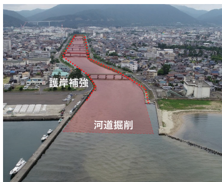
【河道掘削・護岸補強：筥の川(3億2,200万円)】
