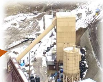
この設備で製造したコンクリートを使用して、ダム本体を造り上げていきます
