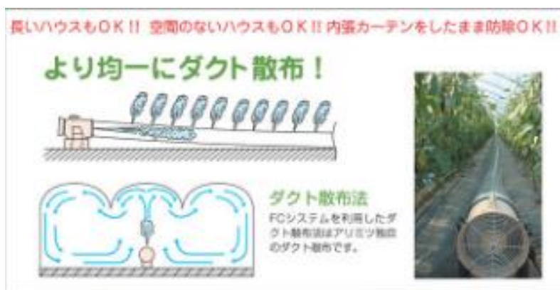
フォガーへのダクト設置により均一に散布する
