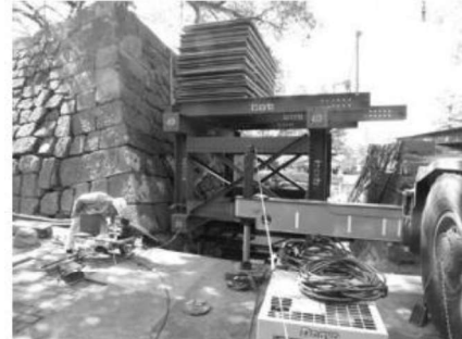
山里口御門復元整備時の載荷試験
