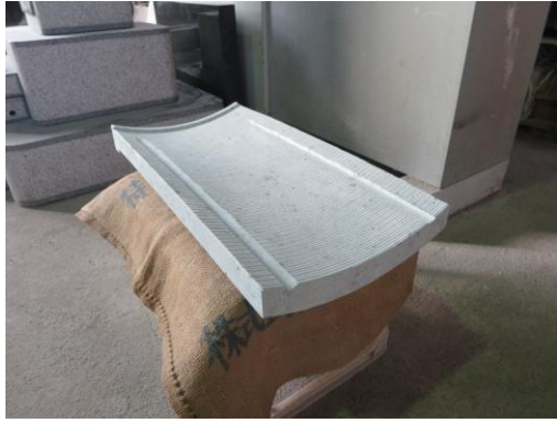
写真9 平瓦（表の水返し）
