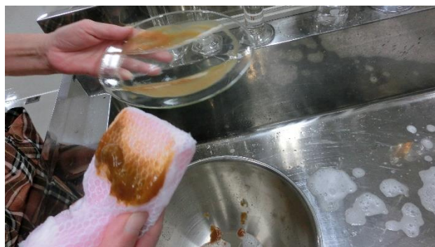
図3 カレーを塗り付けた時計皿をスポンジでこすった時の様子
