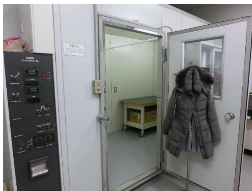
図2 プレハブ型恒温恒湿室の外観
