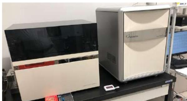
図2. 熱分解型元素分析・質量分析計システム
