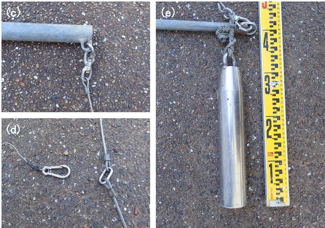
図9. 続き。(c) 単管と側方ワイヤーの接続部。(d) 側方ワイヤーとヒシ刈り用ワイヤーの接続部。(e) 側方ワイヤーおよび鉄棒と分銅の接続部。
