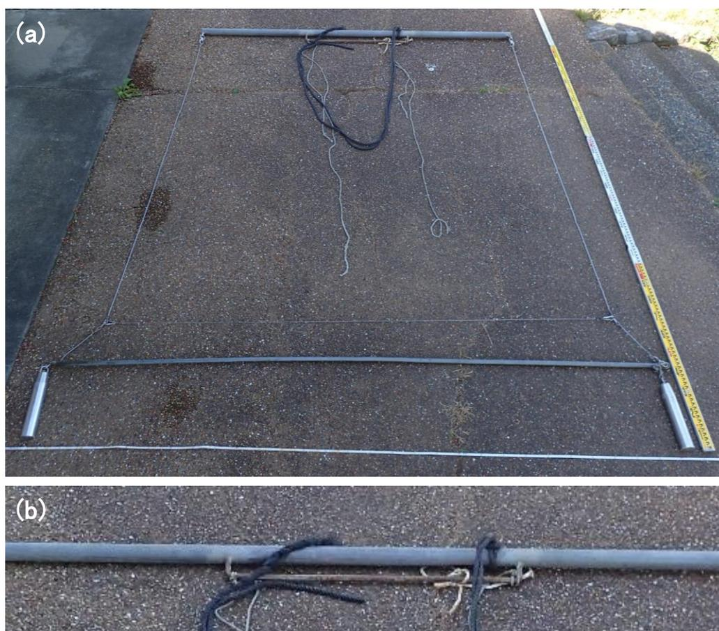
図 9. ワイヤー刈り装備の詳細。(a) 全景。(b) 小型船舶への単管の接続部。
