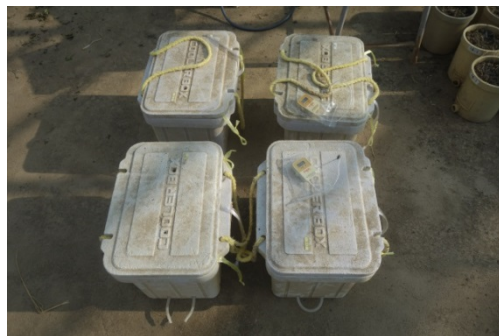
写真1 簡易堆肥化装置
