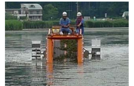
ヒシ刈り専用の機械による刈り取りの様子
