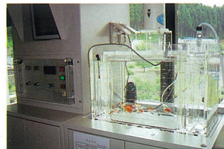
水質安全監視装置
