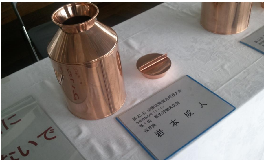
第33回全国建築板金競技大会 (H23) で優勝した作品 ・課題は直径18cmの円筒状の「ミルクタンク」。 ・4時間の制限時間内に展開図を描き、銅板を部品ごとにカットし、ハンダで接着させて仕上げる。
