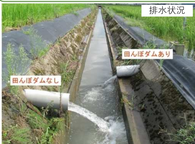
写真 「田んぼダム」のありなしによる排水状況の違いと貯留状況の違い
