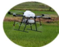
マップに合わせてドローンで肥料を自動散布
