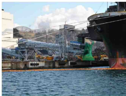
木質チップ船からベルトコンベアにチップを降ろしている状況
