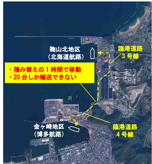
内貿 RORO 貨物の横持ち状況
