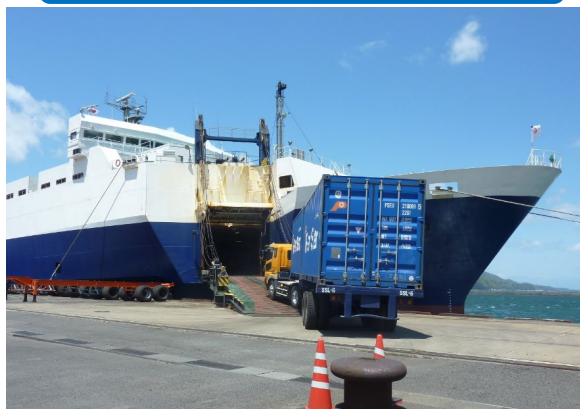
RORO船の荷役状況
