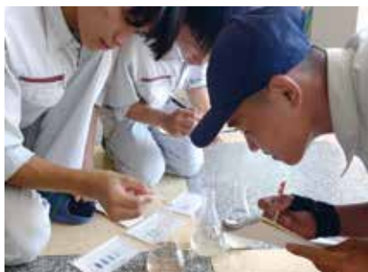
パックテストによる水質調査
