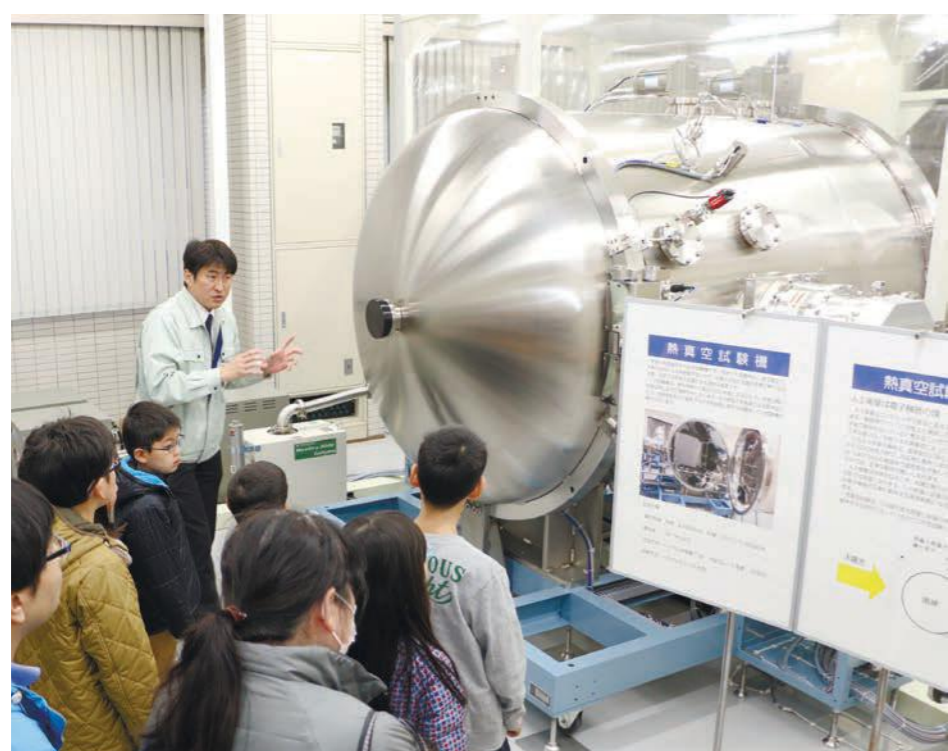
真空状態で熱への強さを試験する設備
