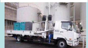
仮設中圧ポンプ
