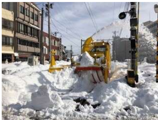
ロータリー除雪車による軌道除雪 (えちぜん鉄道 福大前西福井駅)
