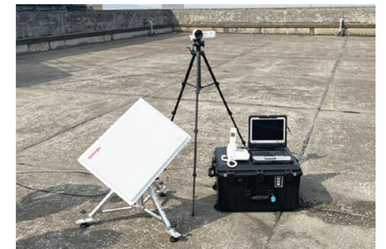
衛星可搬局設備
