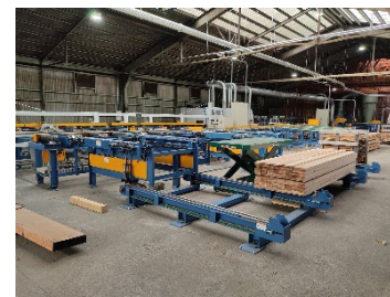
製材品の強度等を測定する機械
