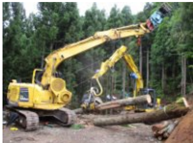
造材・集材の作業状況
