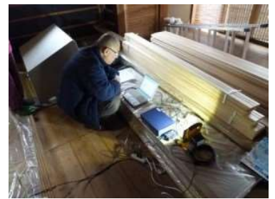
伝統耐震診断での測定
