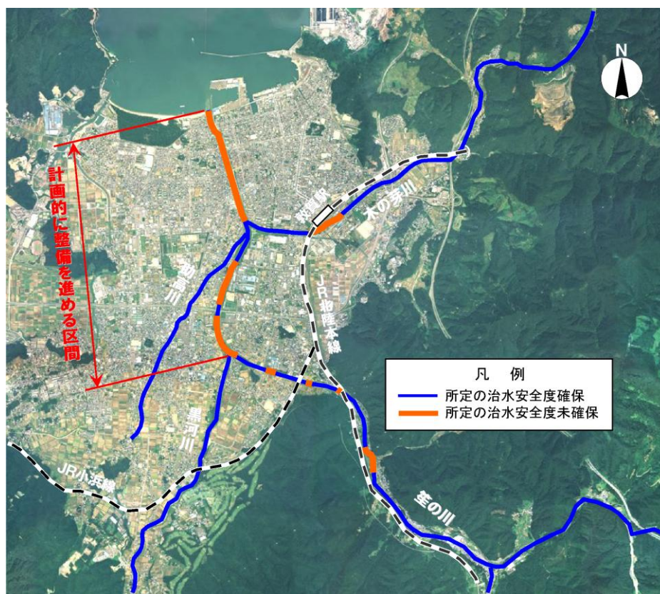
図 3.1.1 河川整備計画の対象区間（計画的に河川工事を実施する区間）
