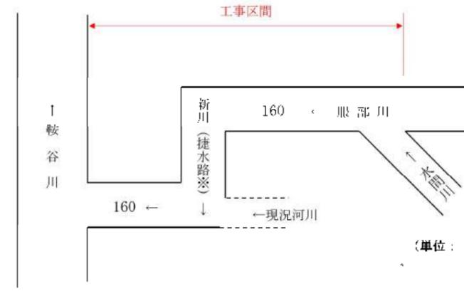
※捷水路(しょうすいろ)：河川の蛇行部をショートカットし、洪水を早く下流へ流すために人工的に開削した水路
