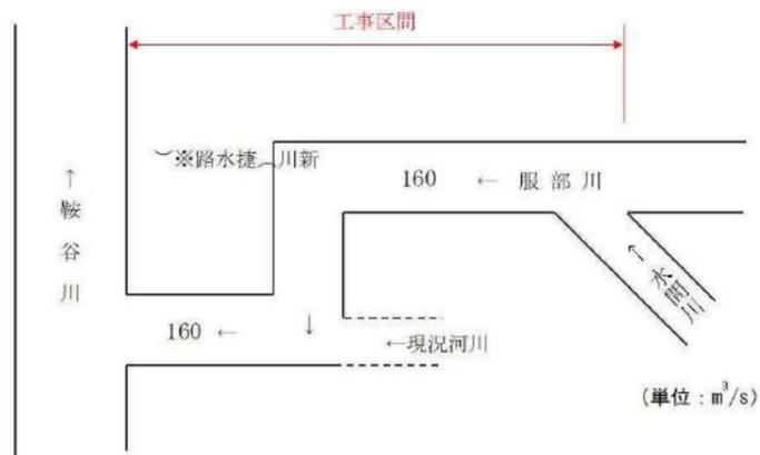
※捷水路(しょうすいろ)：河川の蛇行部をショートカットし、洪水を早く下流へ流すために人工的に開削した水路
