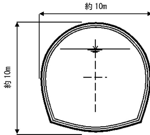
図 4.1.4 トンネル放水路の断面図（イメージ）
