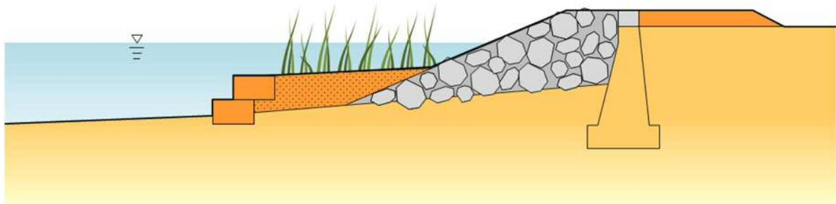
図 4.1.5 湖岸堤嵩上げの横断面図（イメージ）
