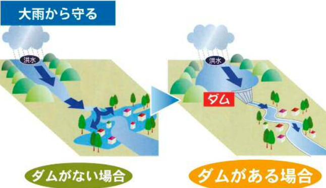
過去に洪水災害をもたらした豪雨のデータなどから、概ね50年に1回の確率で発生すると考えられる洪水を安全に流下させます。
