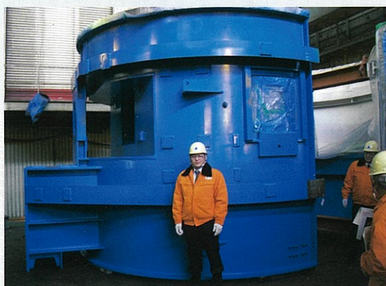
倉敷市内の工場内で製作されている回転ガントリーの一部
