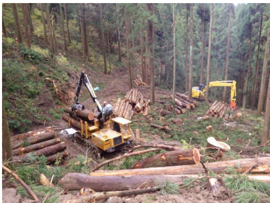
フォワーダへの積込作業
