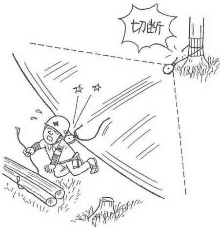
作業索の内角側の危険箇所
