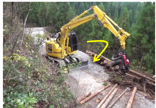
② 機体を旋回させながらの木を引き出し、最初の鋸断位置を調整
