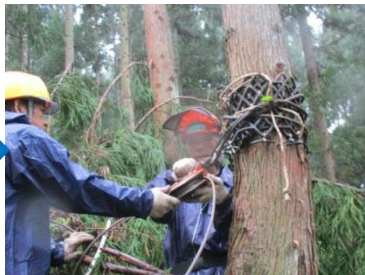
④ 滑車を取り付け、引戻索を搬器に取り付け
