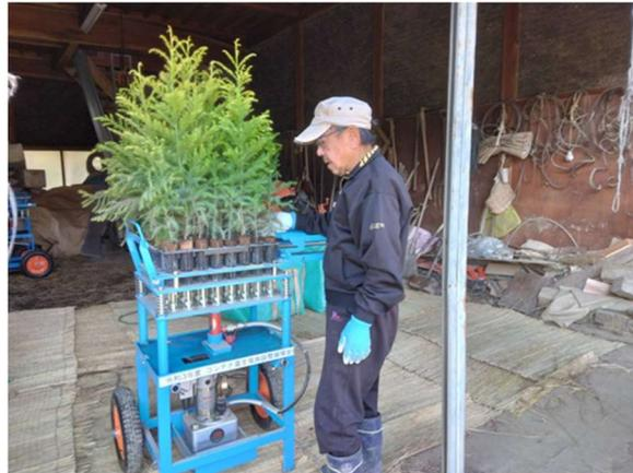
写真21 コンテナ苗抜き取り機による作業状況
