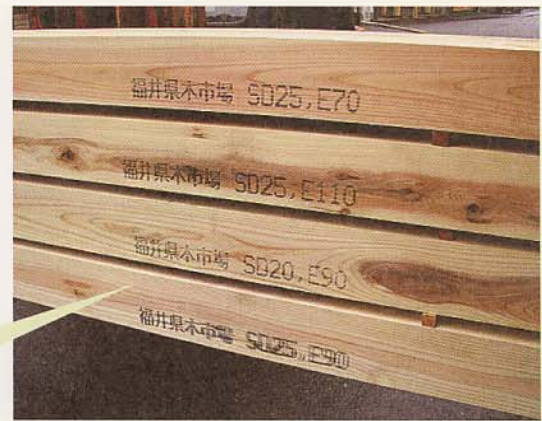
強度・含水率を明確にした製材品 (写真の製材品は柱として利用されます)
