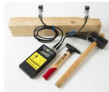
写真 応力波速度測定器 (FAKOPP)
