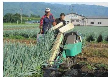
ネギの機械化一貫体系（掘取機）
