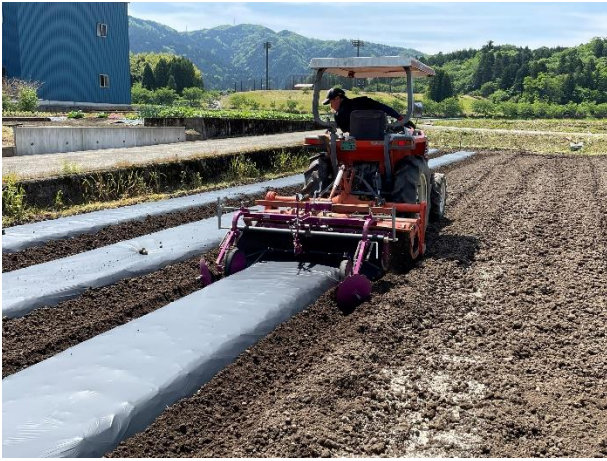
写真2 機械による生分解性マルチの展張
