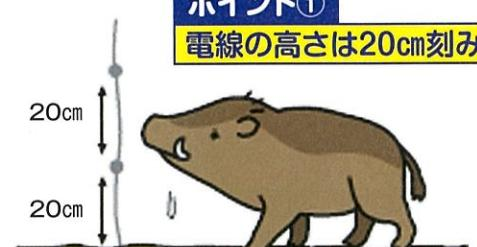
最下線の電線は、必ずイノシシが鼻で探る位置（地面から20cm）にくるようにします。
