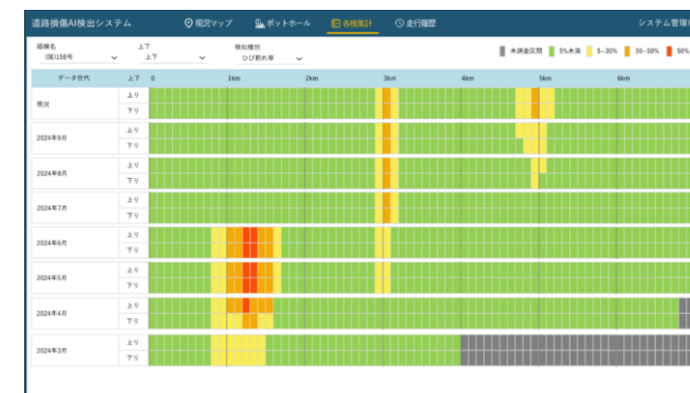
劣化状況の時系列表示
