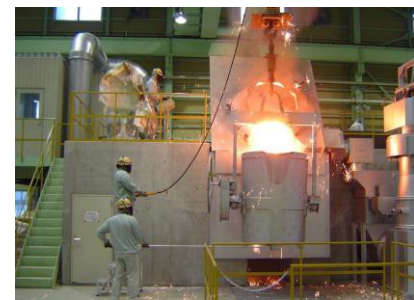
【クリアランスレベルの廃棄物(金属)再利用のための casting 設備(例)】
