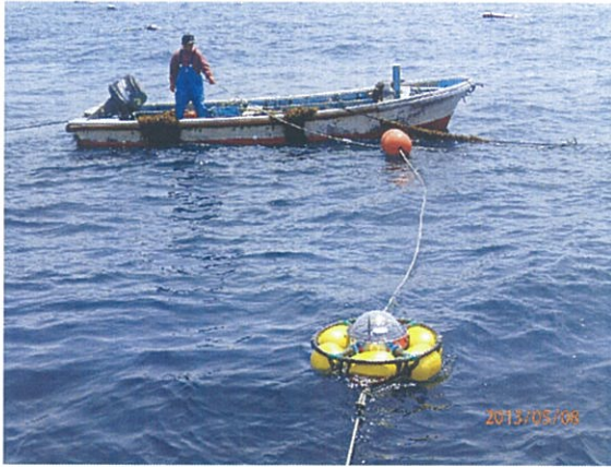
図3 漁場に設置した海洋環境観測ブイ
