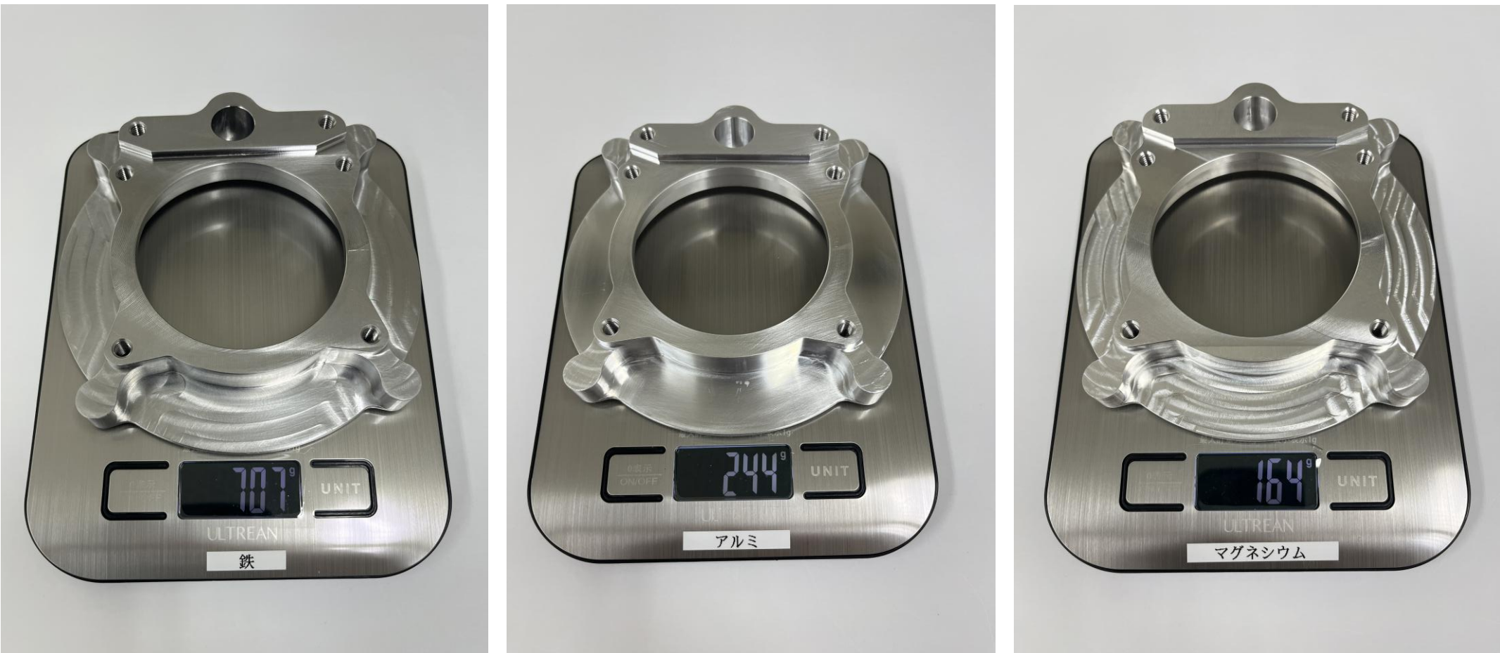
図 加工した鉄（左）、アルミニウム合金（中）、 マグネシウム合金（右）の重量比較
