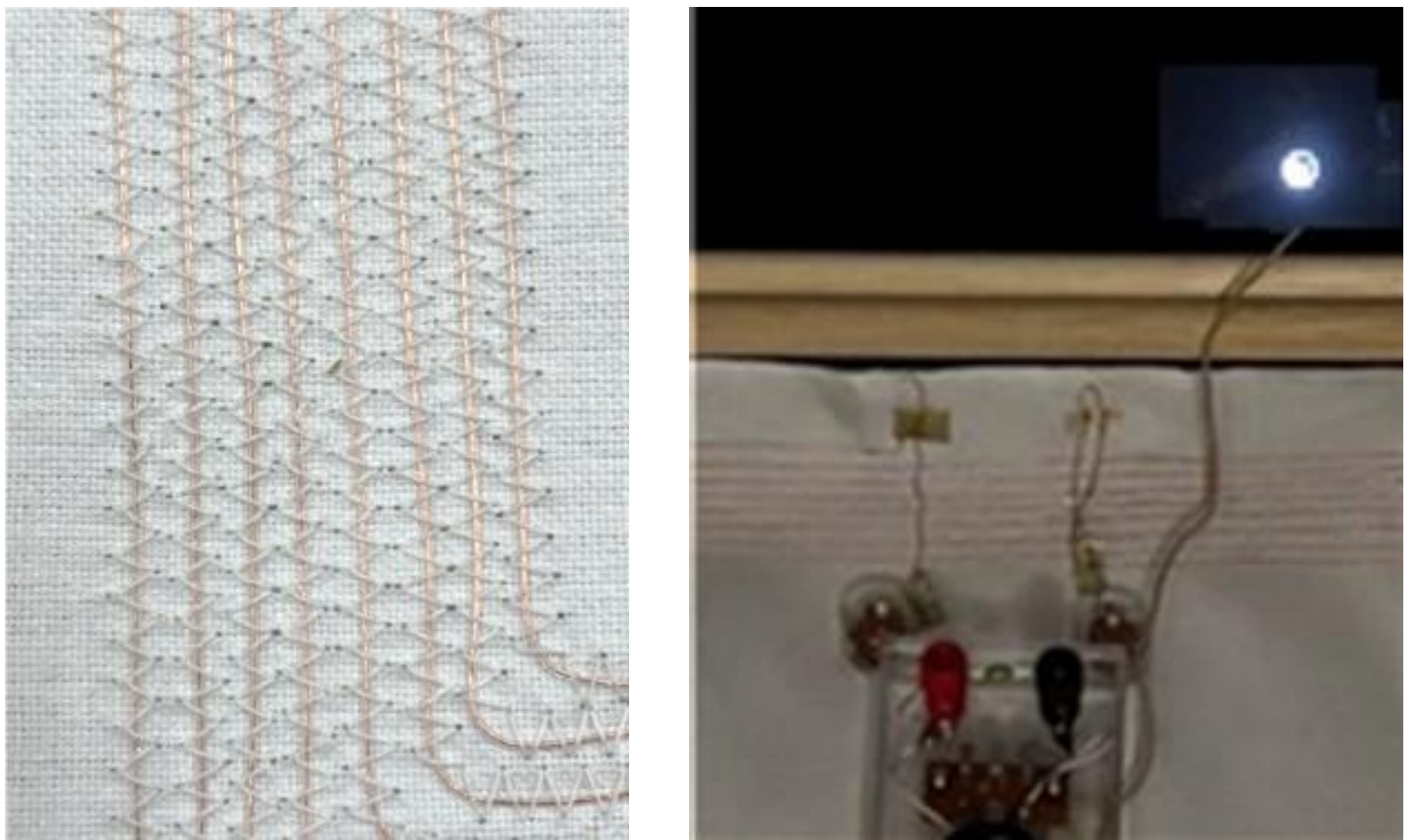
図 縫製した導電糸アンテナ（左）と受信してLEDが点灯する様子（右）
