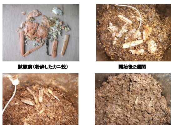
図6 試験2におけるカニ殻形状の推移
