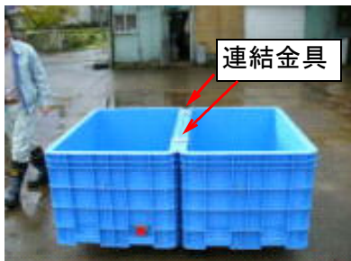
写真4 金具で2台のコンテナを連結
