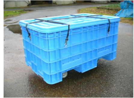
写真2 金具を取付け、チューブで蓋を押さえる
