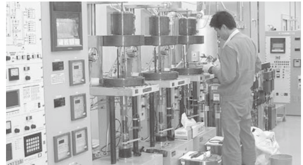
▲腐食試験装置を用いた高温高压水中での応力腐食割れ試験
