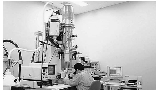
▲材料のマイクロ組織観察を行う電界放射型透過電子顕微鏡
