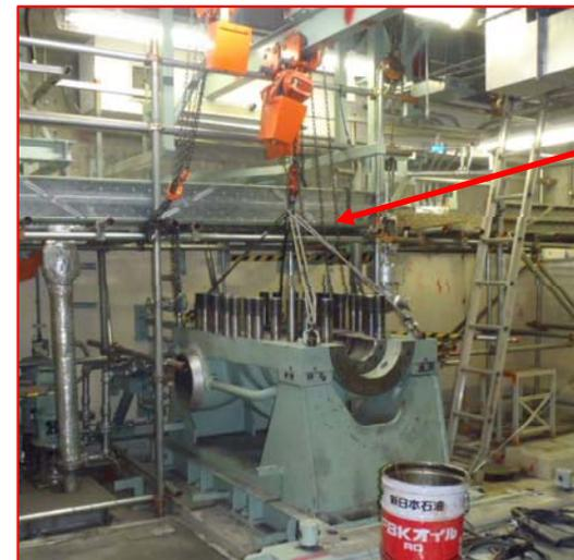
ホイストを用いた重量物の運搬（玉掛け、合図）
